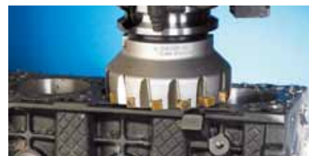
Specjalna głowica do obróbki zgrubnej żeliwa.
