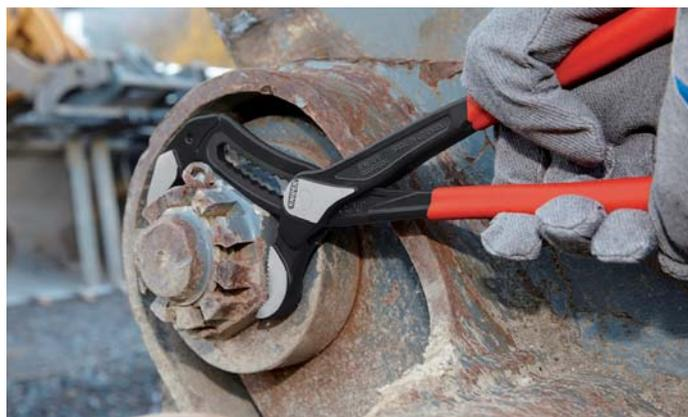
Szczypce KNIPEX Alligator® XL oferują wydajność i komfort właściwy szczypcom do rur przy jednoczesnym zmniejszeniu wagi o 50 % i zwiększeniu zakresu chwytu (3 1/2") w stosunku do porównywalnych kluczy do rur.
