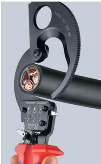
95 31 280: Duży zakres cięcia: średnica maks. Ø 52 mm / przekrój 380 mm<sup>2</sup>
