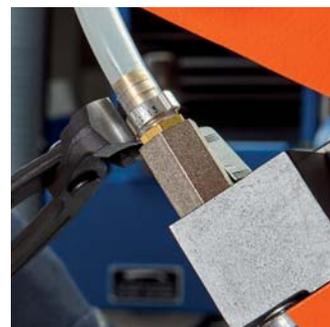
Uszczelnianie połączeń węży w układzie centralnego smarowania
