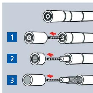
Ściąganie izolacji z kabli koncentrycznych w 3 krokach
