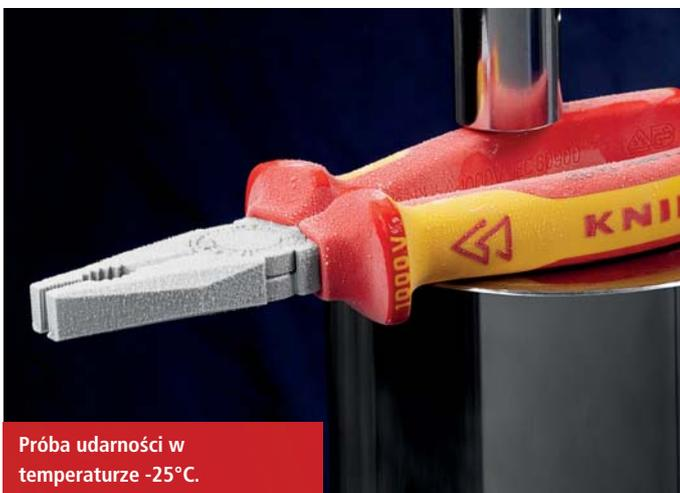
Próba udarności w temperaturze -25°C.
