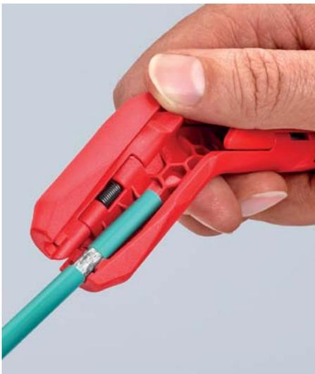
Usuwanie izolacji z przewodu teleinformatycznego
