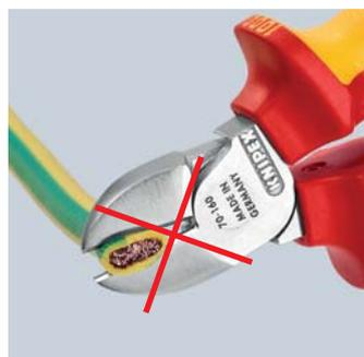
Cięcie za pomocą szczypek bocznych: wymaga dużej siły, cięcie jest niedokładne, kabel zostaje poważnie zdeformowany i zgnieciony
