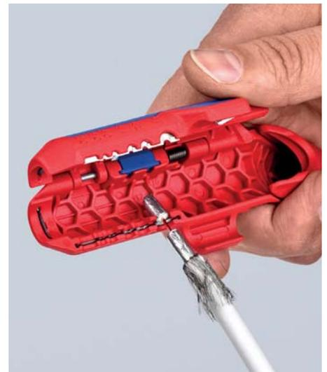
Usuwanie izolacji z przewodów koncentrycznych
