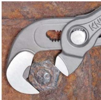
Do odkręcania zapieczonych nakrętek z zaokrąglonymi krawędziami
