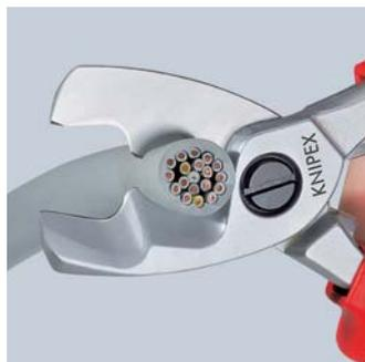
Docięcie: jeżeli do przecięcia kabla wymagana jest większa siła, można użyć ostrza znajdującego się w pobliżu złącza nożyc. Cięcie wstępne za pomocą ostrza przedniego – docięcie za pomocą ostrza tylnego
