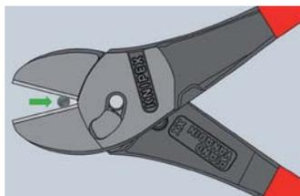
Naciąć wstępnie drut przy użyciu szczypiec KNIPEX TwinForce® do momentu, gdy siła potrzebna do przecięcia znacznie się zwiększy. Otworzyć szczypce i przesunąć drut wzdłuż nacięcia w kierunku złącza.
