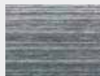
Ściernica listkowa nasadzana o granulacji 40 obraz szlifu: linie długie, minimalne zagłębienia, gładkie wykończenie
